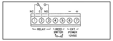
Fig. 2. Wiring Diagram. Also see Fig. 3.
