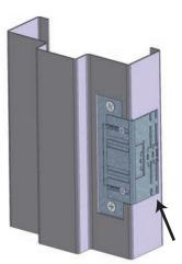
THE TEMPLATE LIP SHOULD SEAT ON THE **FACE OF THE FRAME** AS SHOWN.
