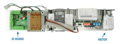
I/O BOARD IS TOWARDS HINGE JAMB MOTOR TOWARDS HINGE JAMB
